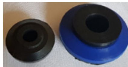
Rys. 3. Zawory o średnicy \varnothing 25 mm i \varnothing 50 mm
