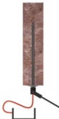
3. Rozprężenie kotwy OMEGA-BOLT® pod wpływem wody pod wysokim ciśnieniem.
